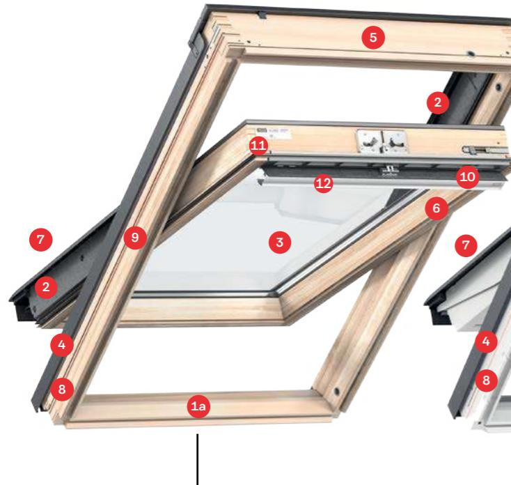
1a Міцний і теплий віконний профіль, виконаний з клееної деревини, покритої лаком на водній основі, у поєднанні з EPS технологією ThermoTechnology™\*
